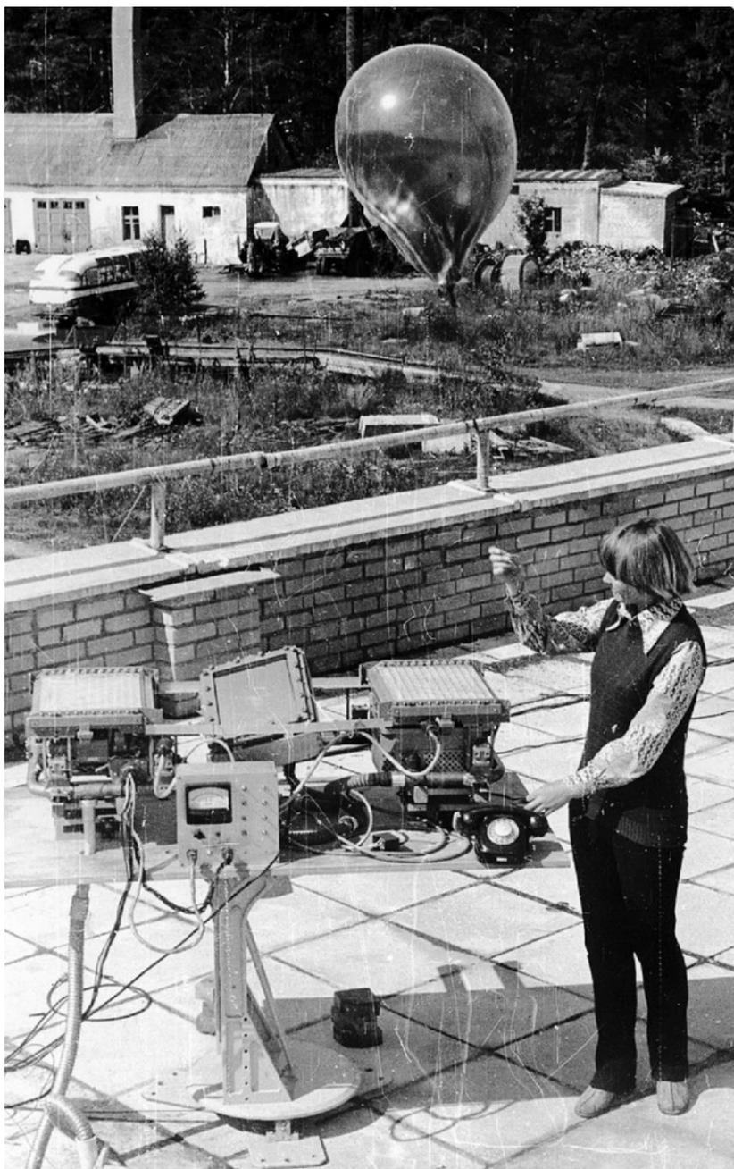
Фото 1. Калибровка установки радиоакустического зондирования прямыми измерениями градиента температуры. 1978 г.
