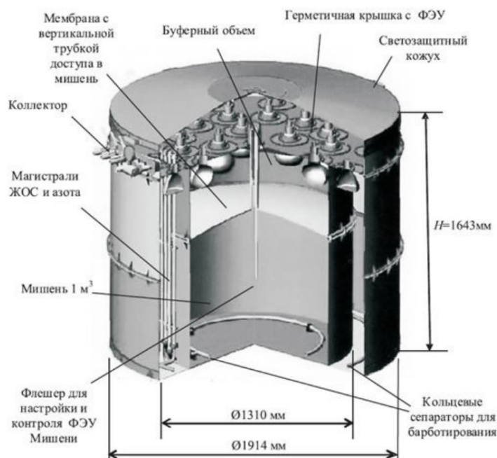
Рис. 3: Конструкция детектора iDREAM
