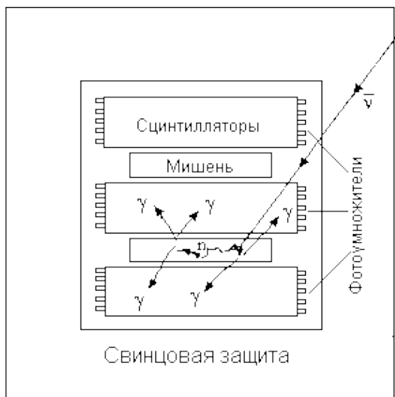
Рис. 1. Схема установки в опыте Коуэна и Райнса.
