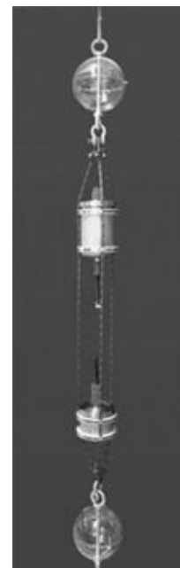
Рис. 9. Внешний вид акустического модуля SPATS.
