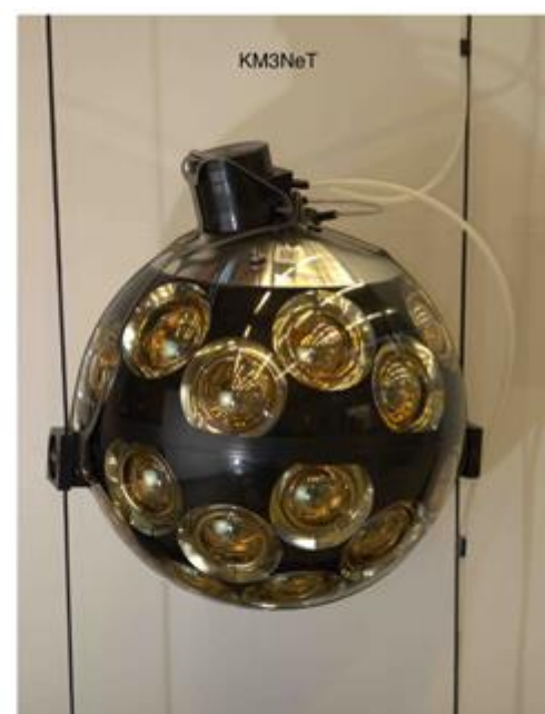
Рис. 4. Слева – гирлянда оптических модулей. Справа – цифровой оптический модуль эксперимента KM3NeT.
