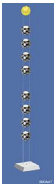
Рис. 4. Слева – гирлянда оптических модулей. Справа – цифровой оптический модуль эксперимента KM3NeT.
