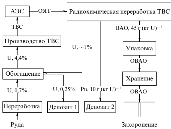
Рис. 1. Схема открытого ядерно-энергетического цикла. Для U указано обогащение по изотопу 235 U. Для Pu и ВАО приведено их содержание в ОЯТ реакторов ВВЭР-1000. (ТВС — тепловыделяющая сборка, ОБАО — остеклованные ВАО.)
