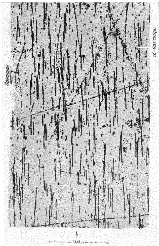
**α- частицы и протоны, получающиеся при расщеплении лития дейтонами**
