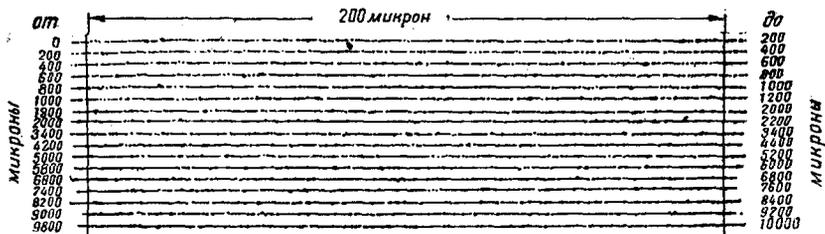
Рис. 21. Изображение последовательных элементов (каждый из которых длиной 200  $\mu$ ) следа ливневой частицы с полной длиной 10 000  $\mu$ . След прямолинеен с точностью 0,05°, а энергия частицы, которая его образует, должна быть больше чем  $1,5 \cdot 10^9$  эв.
