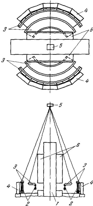
Рис. 10. Схема расположения регистрирующей системы на установке ВЭП-1.
