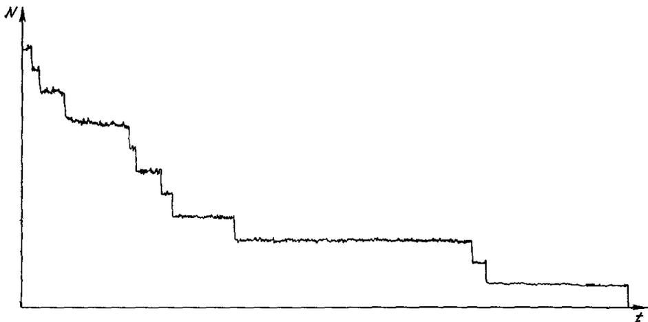
Рис. 6. Кривая уменьшения интенсивности синхротронного излучения пучка электронов.
