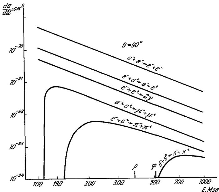
Рис. 13. Энергетическая зависимость сечений мёллеровского рассеяния и двухчастичных процессов, идущих при взаимодействии позитронов с электронами.
