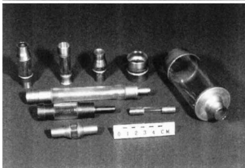
Рис. 2.27. Искусственный корунд (лейкосапфир) и изделия из него: а – профилированные кристаллы; б – шлифованные и полированные изделия; в – металлокерамические узлы с изоляторами из лейкосапфира
