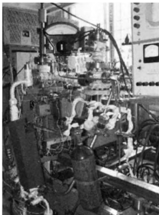
Рис. 2.22. Экспериментальная база по исследованию термоэмиссионных преобразователей (стенд для исследования газорегулируемой тепловой трубы)
