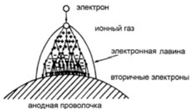
Рис. 8.5. Схема образования лавины на анодной проволоочке в пропорциональном счетчике. Каплеобразная лавина образуется за счет боковой диффузии [11, 29]
