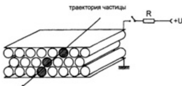
Рис. 8.2. Принцип действия камеры на разрядных трубках [11]
