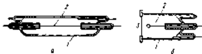
Рис. 3.8. Различные типы газонаполненных счетчиков: а) цилиндрический; б) торцовый
