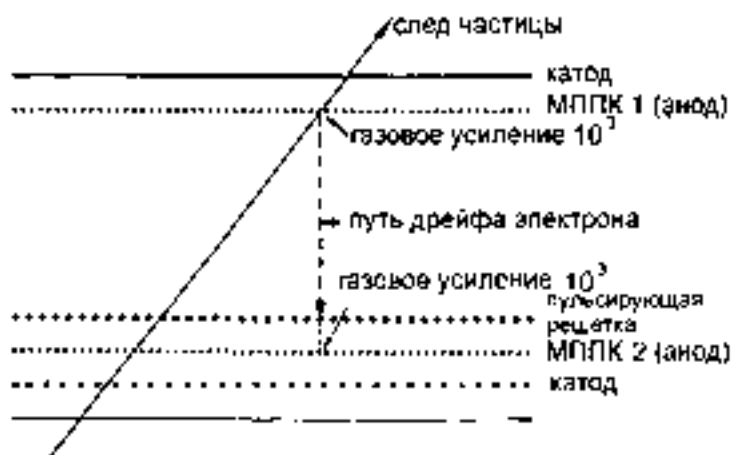
Рис. 8.19. Принцип работы многоступенчатой лавинной камеры [85]
