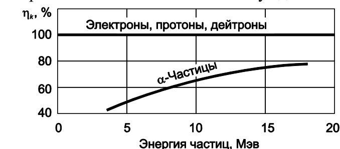
Рис. 4.7. Влияние типа заряженных частиц на конверсионную эффективность неорганического сцинтиллятора NaI(Tl) [14, 15]
