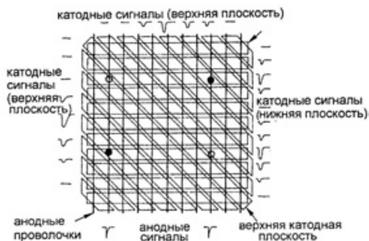
Рис. 8.8. Неоднозначность разрешения при регистрации треков двух частиц в многопроволочной пропорциональной камере [11]
