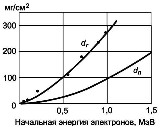
Рис. 2.14. Нормальная толщина d_n и толщина обратной диффузии d_r для случая нормального падения. Экспериментальные точки приведены для Al [8]
