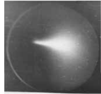
Рис. 2.18. Иллюстрация диффузного рассеяния тонкого моноэнергетического электронного пучка с энергией 6,45 МэВ в ПММА
