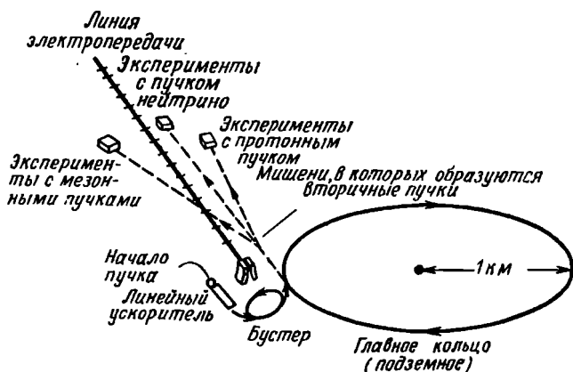
Рис. 4.1. Национальная лаборатория ускорителей им. Ферми (FNAL) в окрестностях Чикаго (США) (схема).
