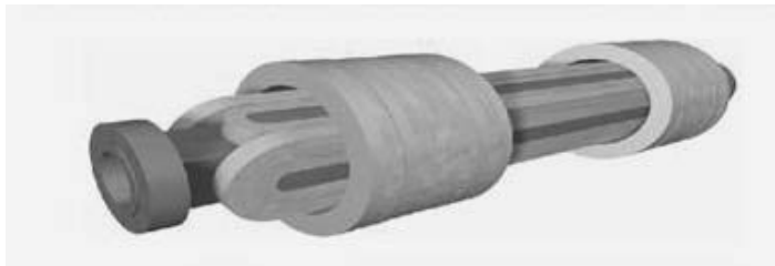
Рис. 3.9. Пример простейшей магнитной ловушки Иоффе–Притчарда для удержания нейтронов
