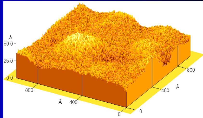
5 nm пленка  $\text{In}_2\text{O}_3$ , осажденная на необлученный РС
