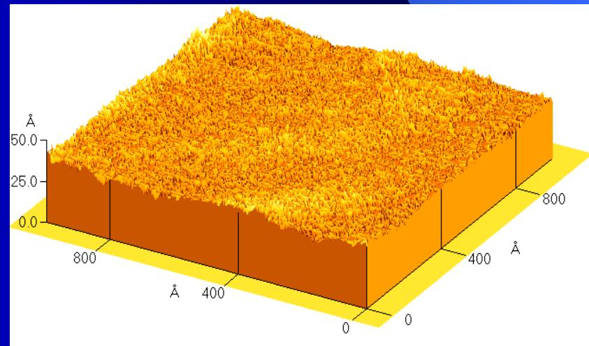
5 nm пленка  $\text{In}_2\text{O}_3$ , осажденная на облученный ионами  $\text{Ar}^+$  РС
