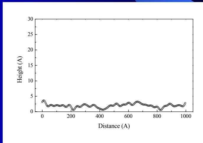
5 nm пленка In<sub>2</sub>O<sub>3</sub>, осажденная на облученный ионами Ar<sup>+</sup> РС
