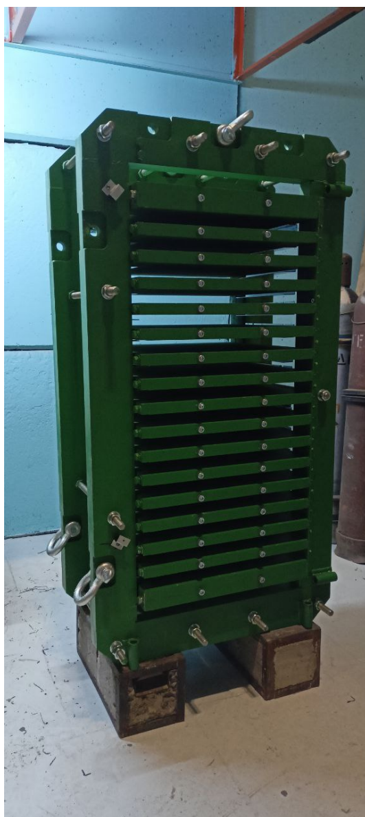
Рисунок 18. Поддерживающая рамка прототипа, установленная в зоне теста пучка.
