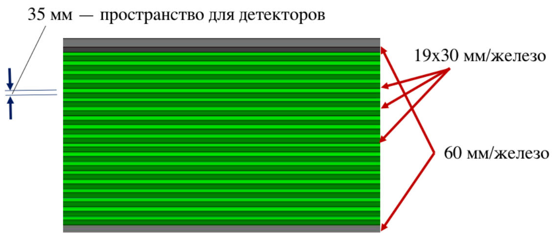
Рисунок 9. Структура пробежной системы детектора SPD.
