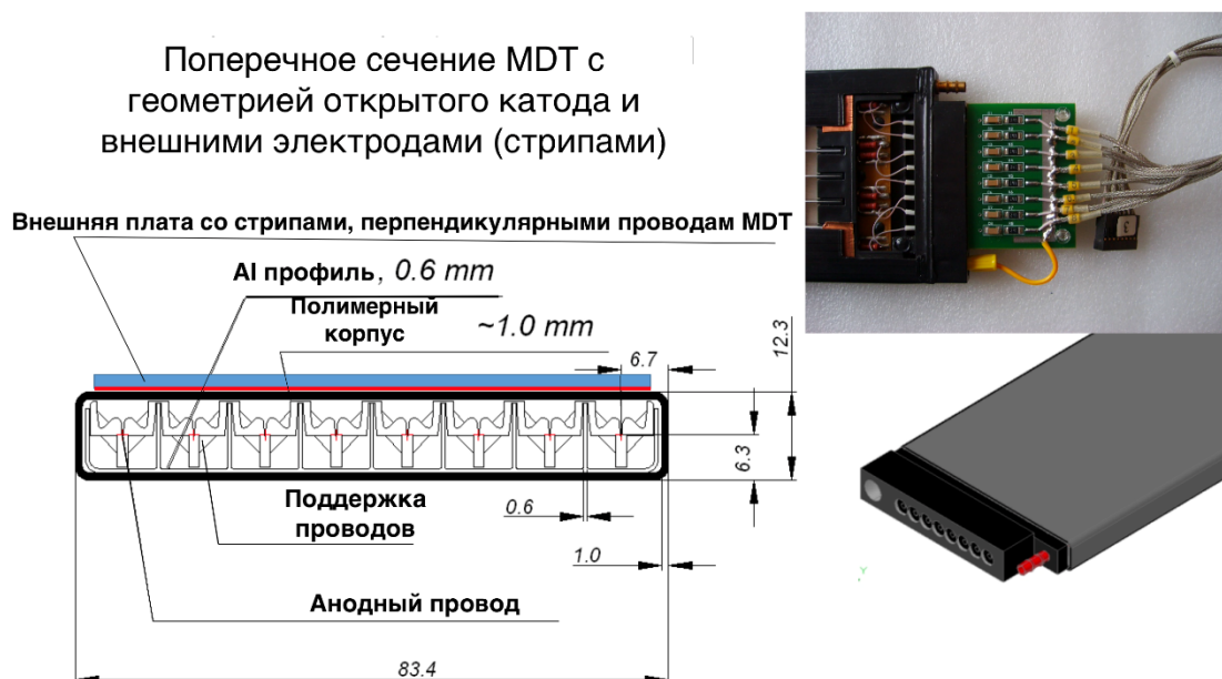
Рисунок 12. Сечение и макет MDT с геометрией открытого катода.
