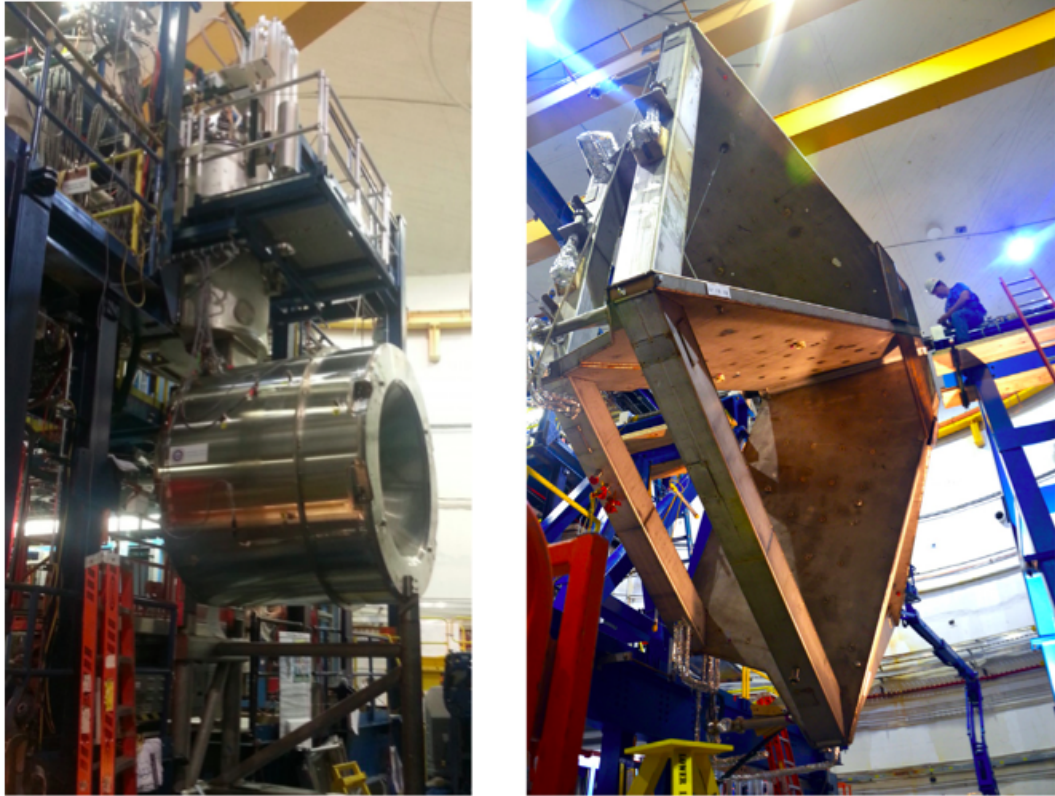
Рисунок 1.5 — Системы магнитов CLAS12 [32]. Слева: полностью собранный соленоидный магнит. Справа: тороидальный магнит.
