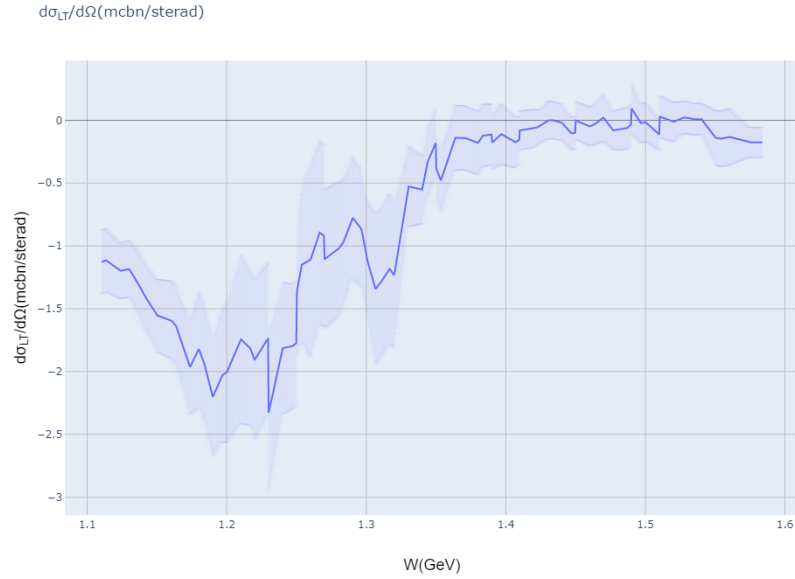
Рис. 6.8: Результат интерполяции \frac{d\sigma_{lt}}{d\Omega} как функции W (ГэВ) для канала \gamma_n p \rightarrow \pi^+ n при Q^2 = 0.35 ГэВ 2 , \cos\theta = 0.3 , E_{beam} = 5.75 ГэВ, \varphi = 30^\circ .
