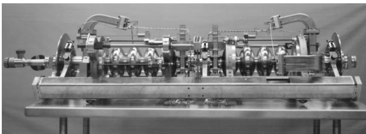
Рисунок 8 – Ниобиевые ускоряющие пятикамерные структуры, длина каждой – 0.5 м.
