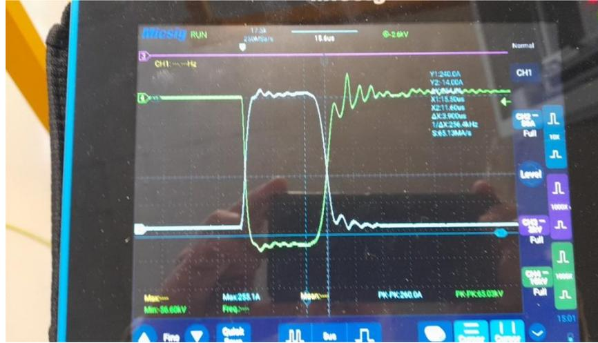
Импульсы высокого напряжения и тока питания клистрона
