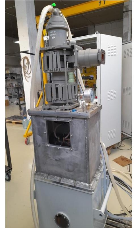
Клистрон КИУ-284 и выходной трансформатор модулятора
