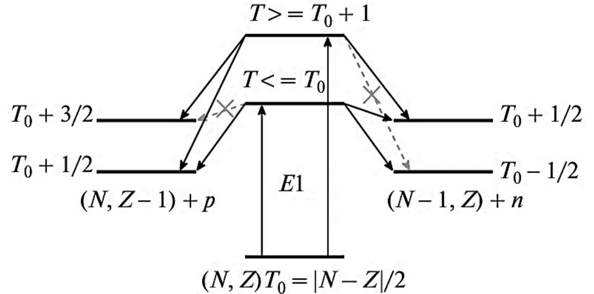
Схема возбуждения состояний  $T_<$  и  $T_>$  в ядре  $(N, Z)$  и их распад по нейтронному и протонному каналам
