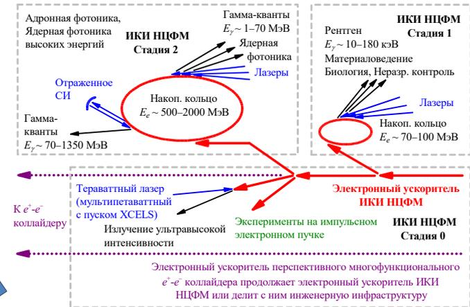
Электронный ускоритель коллайдера продолжает ускоритель ИКИ НЦФМ Или делит с ним инженерную инфраструктуру
