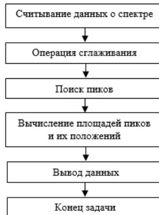
Рис. 17: Блок-схема обработки линейчатых спектров
