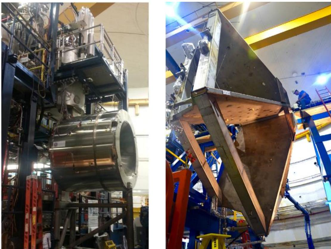
Рисунок 3 – Магнитная система CLAS12. Слева - полностью собранный соленоидальный магнит, справа - тороидальный магнит.
