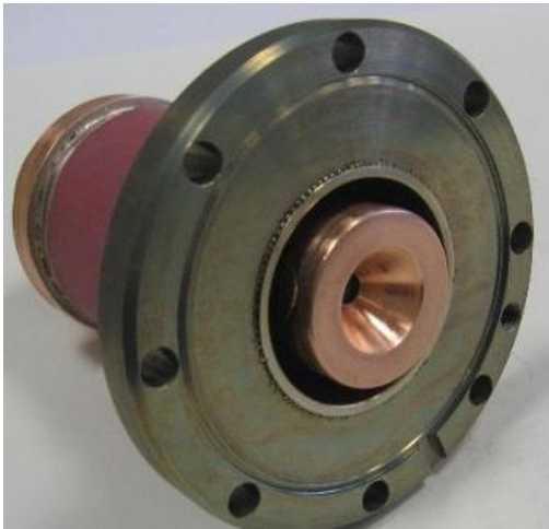
Рис. 2. Внешний вид электронной пушки и ее положение на стенде ускорителя.
