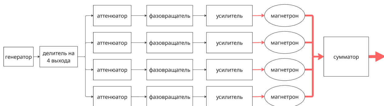
Рис. 50 – Схема суммирования четырех магнетронов
