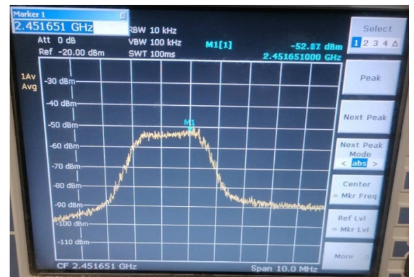
Рис. 18 – Спектры магнетрона №4 при уставке входной мощности БП 2000 Вт (слева) и 2500 (справа).
