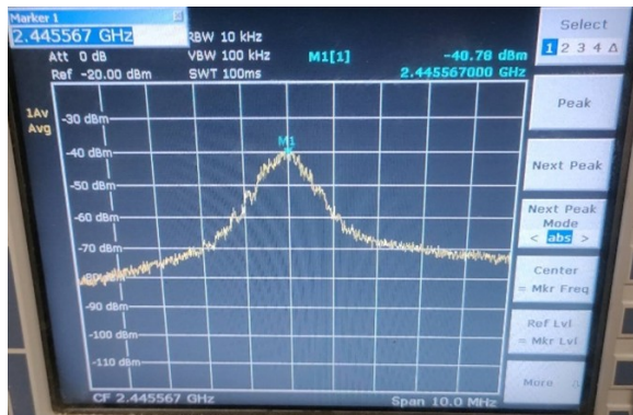
Рис. 17 – Спектры магнетрона №4 при уставке входной мощности БП 1000 Вт (слева) и 1500 (справа).
