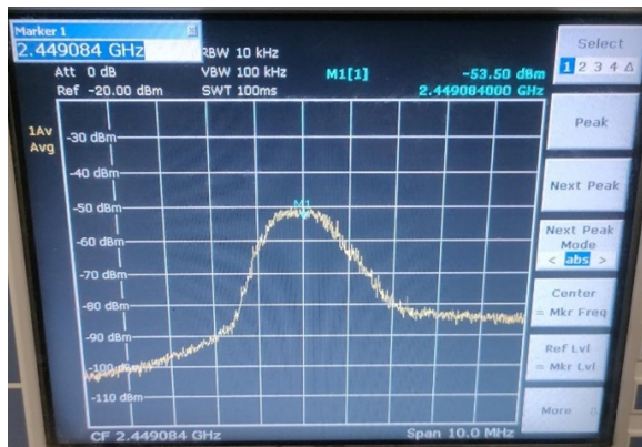
Рис. 18 – Спектры магнетрона №4 при уставке входной мощности БП 2000 Вт (слева) и 2500 (справа).
