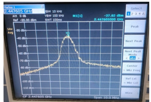
Рис. 17 – Спектры магнетрона №4 при уставке входной мощности БП 1000 Вт (слева) и 1500 (справа).
