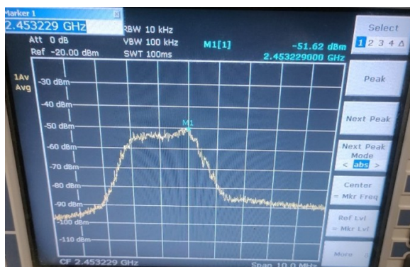
Рис. 19 – Спектры магнетрона №4 при уставке входной мощности БП 3000 Вт (слева) и 3500 (справа).
