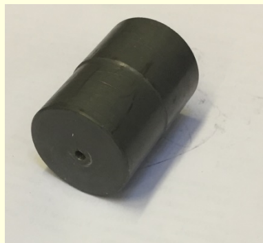
Рис. 55. Внутриканальный коллиматор с диаметром отверстия 3 мм.
