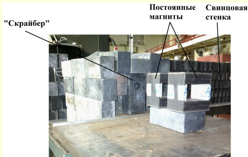
Рис. 33. Вид постоянных магнитов (10), коллиматора K_3 («скрайбер») (11) и продолжительной свинцовой стенки (12).
