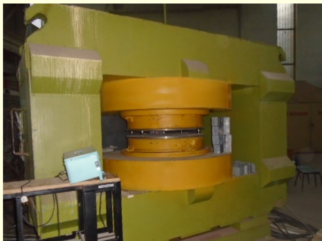
Рис. 35. Общий вид магнита СП-57 с межполюсными вставками (а) и зависимость поля в центре магнита СП-57 от тока питания обмоток и расстояния между полюсами L: 1 – L = 10 см; 2 – L = 6 см.
