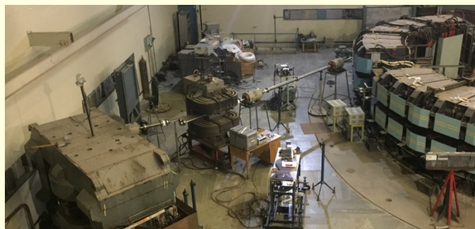
Общий вид магнитооптического канала (МОК) транспортировки выведенного электронного пучка в ускорительном зале.
