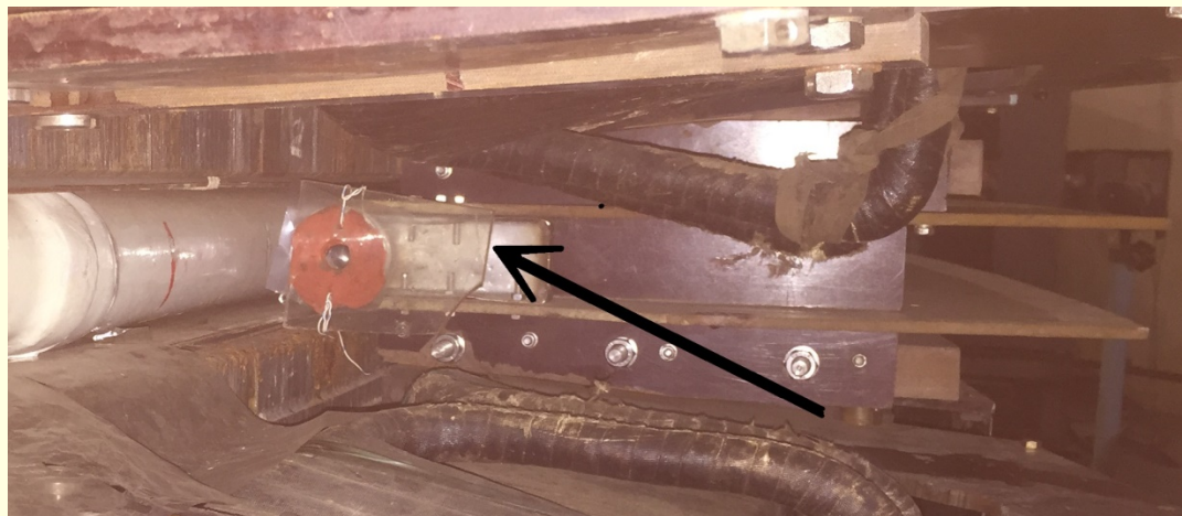
Рис. 54. Входной фланец компенсатора магнитного поля (по стрелки).
