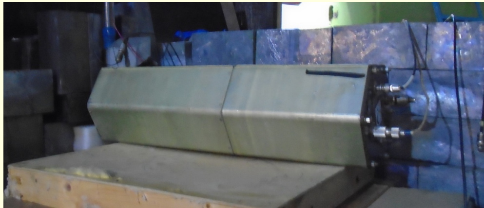
Рис. 39. Черенковский спектрометр полного поглощения (ЧСПП).
