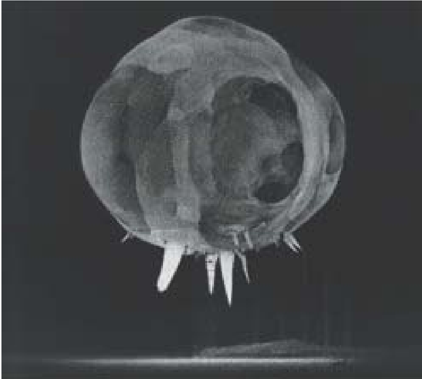
Ядерный взрыв; скорость затвора Керра в камере - до 10 наносекунд ( 10^{-8} ). Harold Edgerton, 1952
