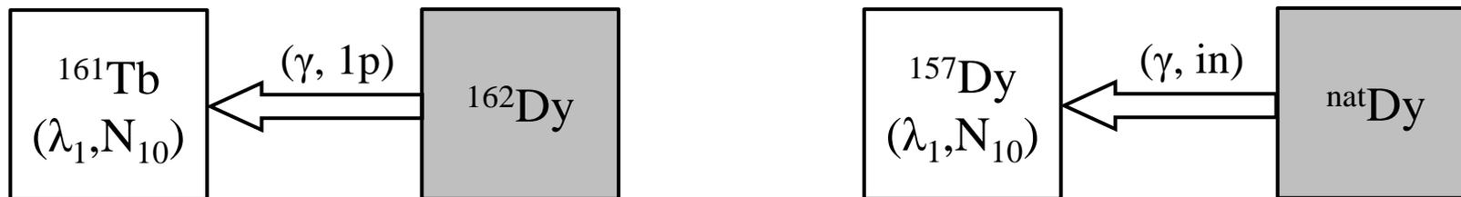
Экспериментальные выходы реакций рассчитывались по площадям фотопиков  $S$  в спектрах остаточной активности с учетом мертвого времени детектора, тока ускорителя во время облучения и нескольких каналов распада, приводящих к образованию исследуемых изотопов:
