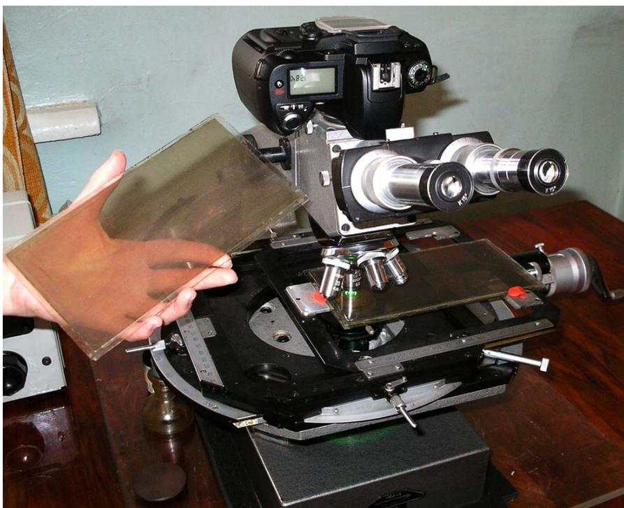
**Рис. 5.** Фотография слоя ядерной эмульсии на стеклянной подложке и микроскопа с установленной фотокамерой.
