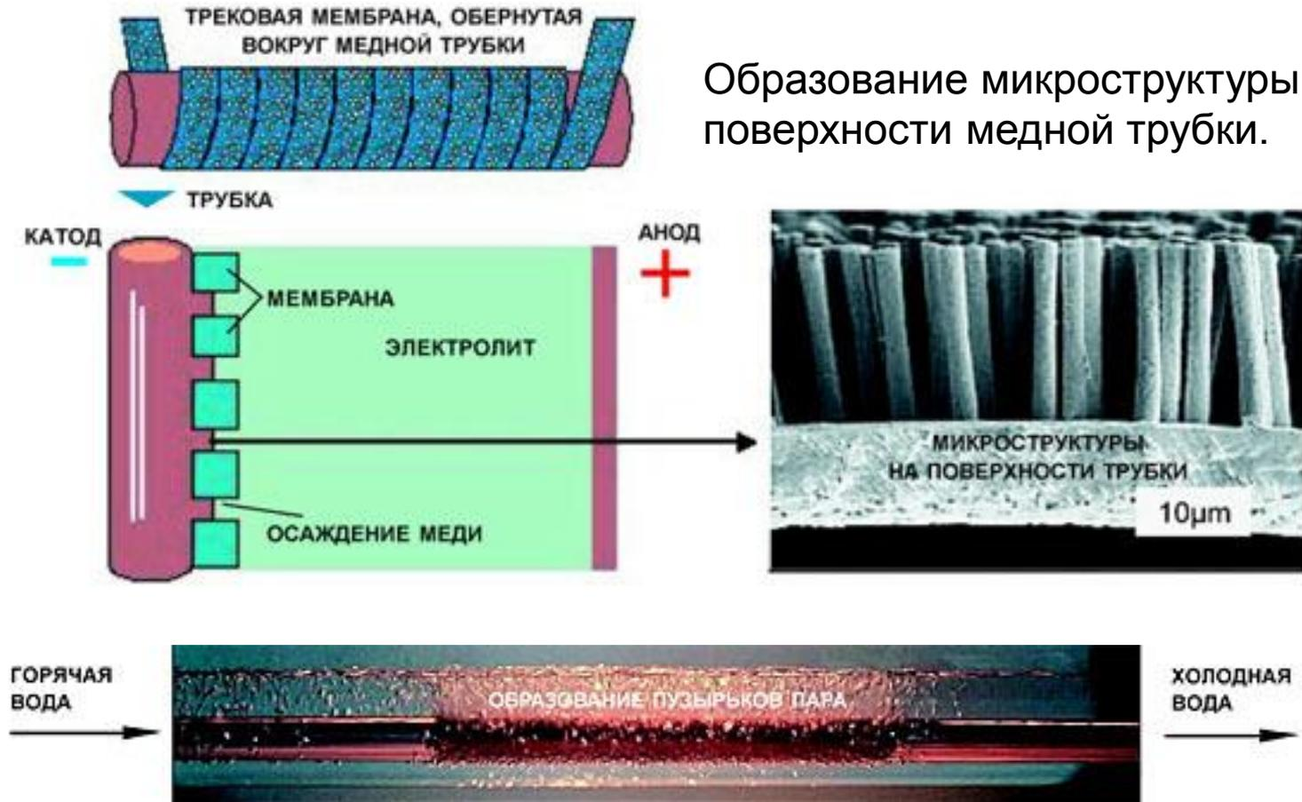
Медная трубка с микроструктурами на поверхности гораздо лучше отводит тепло, чем гладкая. На фото видно, что на участке с микроструктурами происходит интенсивное кипение охлаждающей жидкости.
