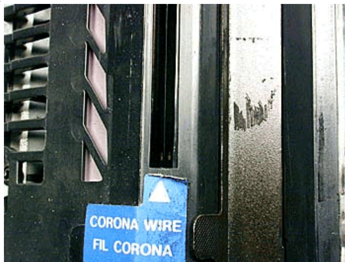
Рис. 5. Устройство коронного разряда
