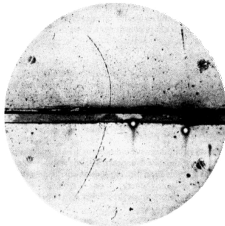
Наблюдение позитрона в камере Вильсона в магнитном поле. Тонкая изогнутая прерывистая линия, идущая снизу вверх – трек позитрона. Темная полоса, пересекающая трек - слой вещества, в котором позитрон теряет часть энергии, и по выходе из которого двигается с меньшей скоростью. Поэтому трек искривлён сильнее.
