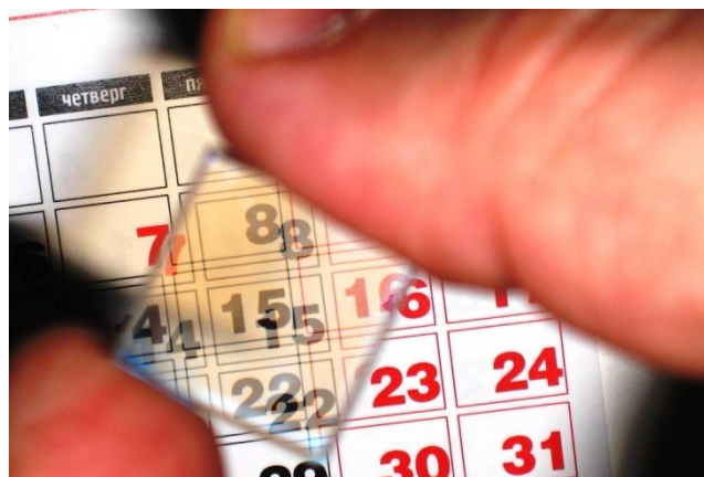
Рис. 2. Двулучепреломление в кристалле исландского шпата.
