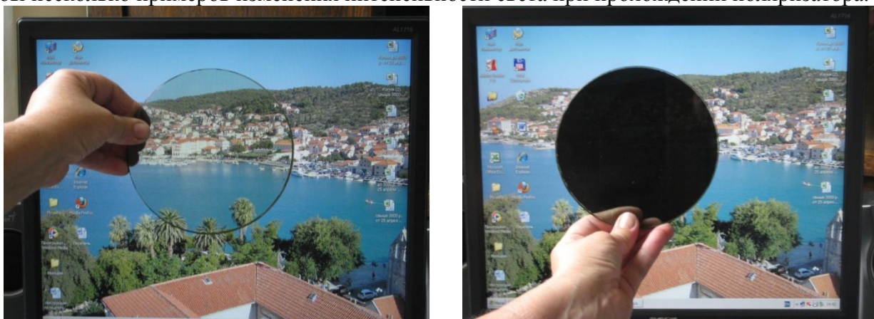
Рис. 1. Гашение изображения на жидкокристаллическом мониторе с помощью пленочного поляризатора
