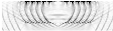
Рис. 6. Волновая картина в системе «вода-грунт».
