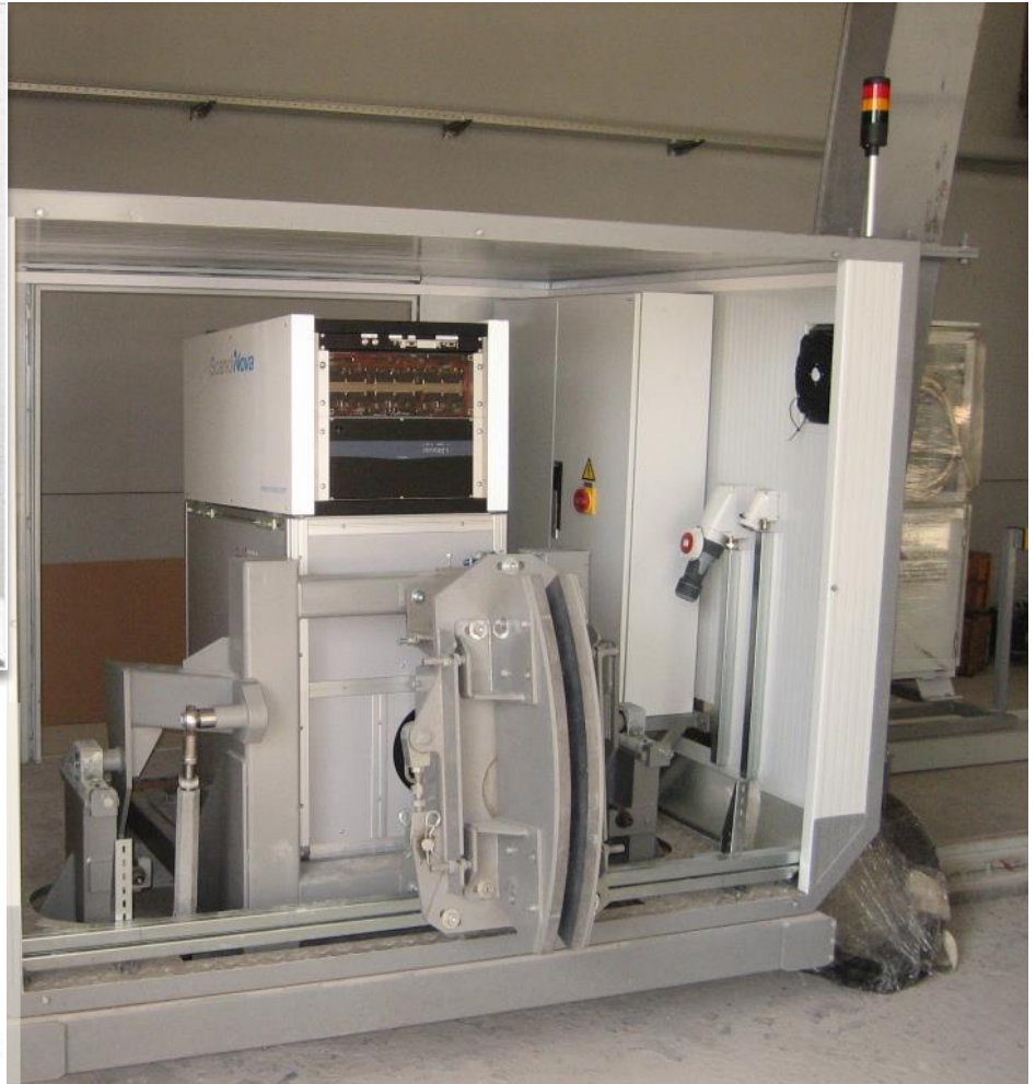
6/3.5 МэВ линейный ускоритель электронов с поимпульсной модуляцией энергии с коллиматором
