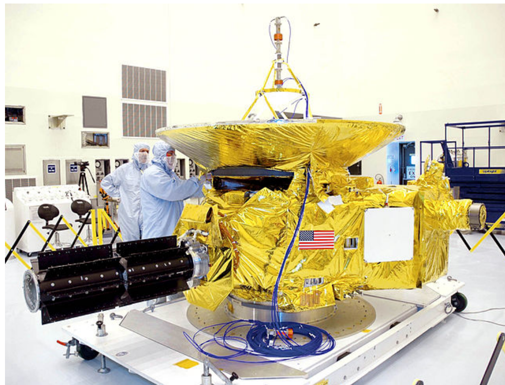
Станция « Новые горизонты » и предназначенная для изучения Плутона, его естественного спутника Харона и объектов пояса Койпера. Запущена в 2006 г. Стартовая мощность РИТЭГ – 228 Вт.
