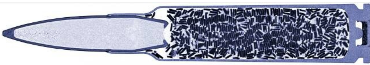
Нейтронная томография (высокое разрешение) вертикальный слой 13 мкм
