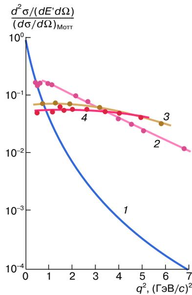
**Рис. 4.** Двойное дифференциальное сечение  $\frac{d^2\sigma}{dE'd\Omega}$  в зависимости от  $q^2$  для неупругого процесса с различными энергиями  $E'$ . Для сравнения показано сечение для упругого рассеяния (кривая 1). Кривые 2, 3, 4 получены при энергиях 2; 3, 5 ГэВ соответственно
