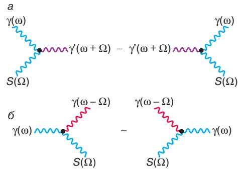
**Рис. 4.** Комбинационное рассеяние: *a* – генерация коротковолнового спутника, *б* – генерация длинноволнового спутника
