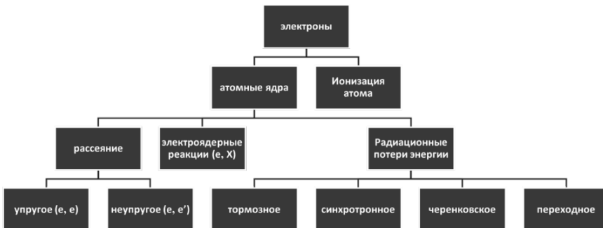
Рис. 3.2.Схема взаимодействия электронов с веществом
