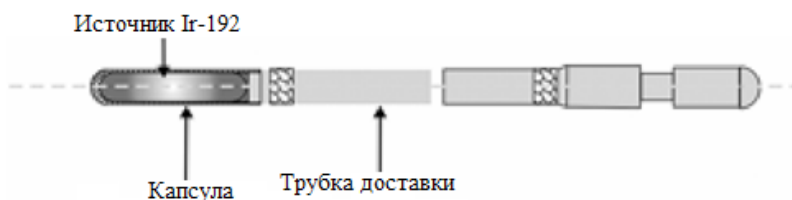
Рис. 10. Типичный источник ^{192}\text{Ir}
