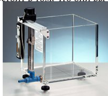
Рис. 8. Водный фантом для проведения дозиметрических измерений
