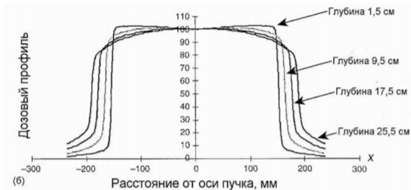
Рис.10. Дозовый профиль пучка тормозного 6-мегаэлектронного излучения на разных глубинах в водном фантоме для размера поля 30 \times 30 \text{ см}^2 на поверхности фантома
