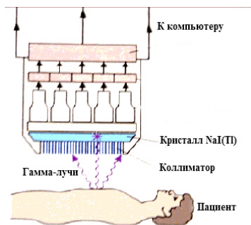
Рис.3.4.4. Устройство гамма-камеры и внешний вид ОФЭКТ
