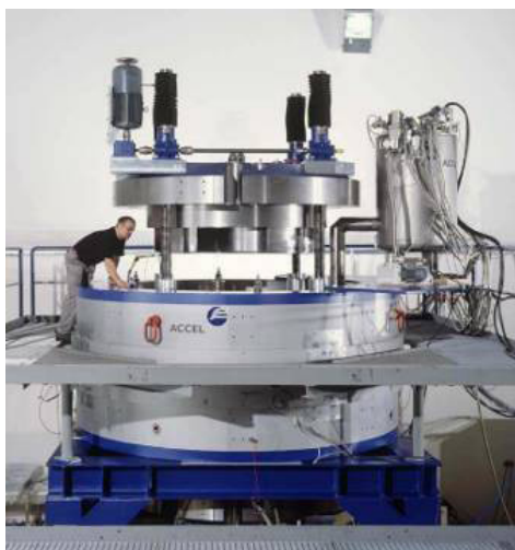
Рис. 3.2.9 Вид на ускоритель Varian Medical Systems с поднятой крышкой (слева), ускоритель в процессе монтажа (справа)
