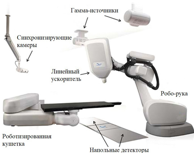
Рис.34. Оборудование «Кибернож» в лечебной комнате
