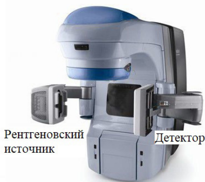
Рис.22. Встроенная визуализация. Рентгеновский источник и детектор
