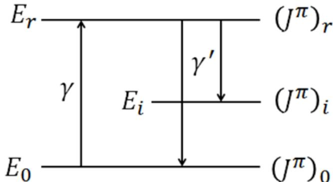
Схема ЯРФ с вариантом  $\gamma$ -перехода из возбужденного состояния ( $E_r$ ) в основное состояние – так называемая «чистая ЯРФ» ( $E_0 \rightarrow E_r \rightarrow E_0$ )
