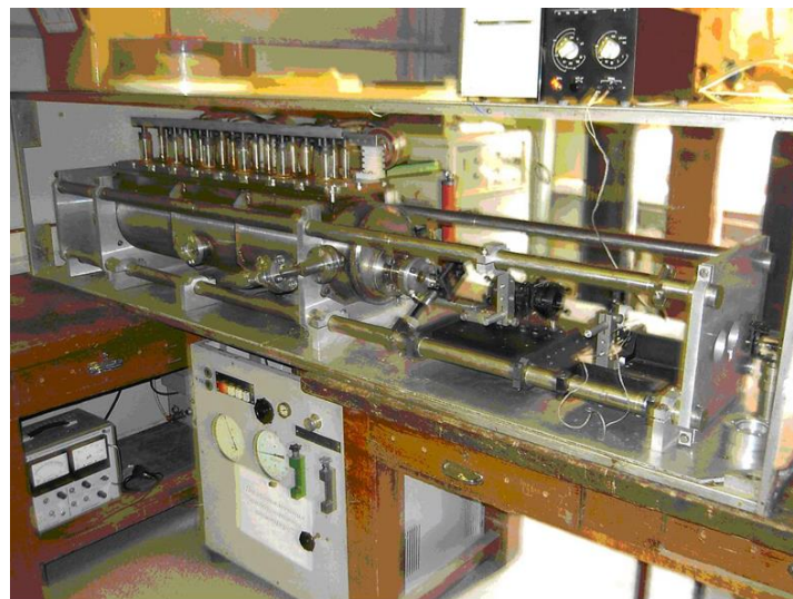
СО 2 лазер, 10.6 мкм, 1 Дж
