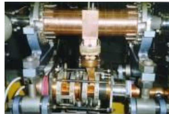
Ускоритель непрерывного действия с магнитным зеркалом с тремя портами пучка.
