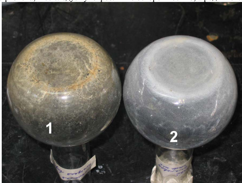
Осадок от выпаривания 0,5 л воды: 1 - водопроводная вода; 2 – родниковая.
