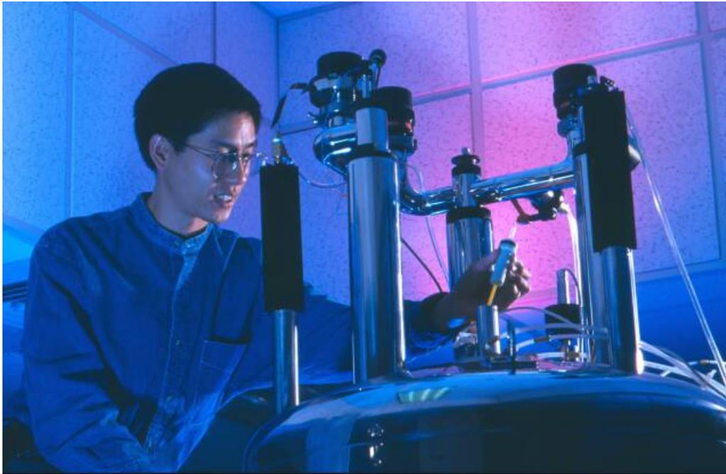
**Один из создателей лабораторного квантового компьютера профессор Айзек Чуанг в Исследовательском центре IBM США помещает колбу с раствором, содержащим невообразимо большое число молекул перфлюоробутадиенила - семикубитовых квантовых компьютеров на ЯМР-сканер.**
