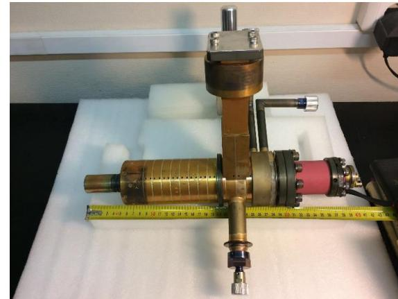
Ускоряющая структура С-диапазона со стоячей волной
