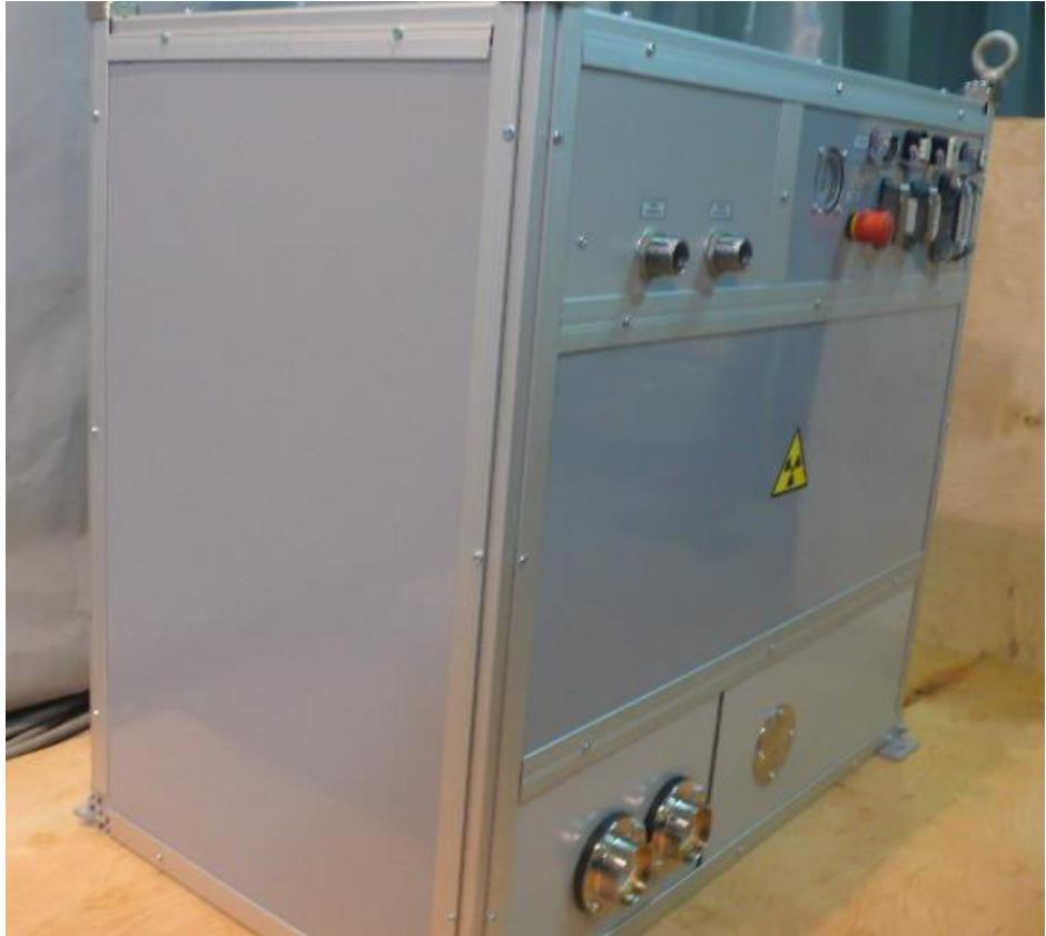
Ускоритель электронов С-диапазона для мобильного инспекционно-досмотрового комплекса УЭЛР-6-0,2-Д-0,6-1, разработанный ООО «ЛЭУ МГУ»
