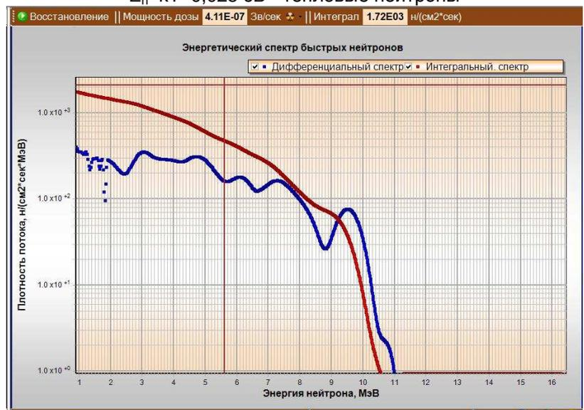
рис.6б Спектр нейтронов  $Pu-Be$  источника в этой лабораторной работе
