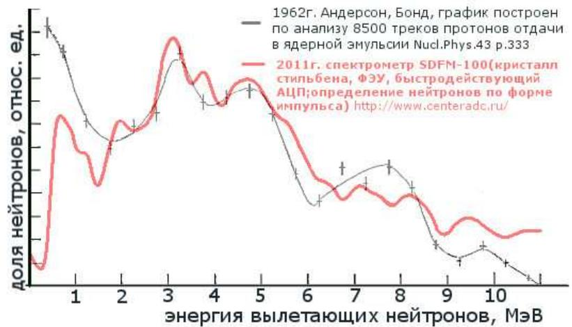
рис.6а Спектр нейтронов  $Pu-Be$  источника.
