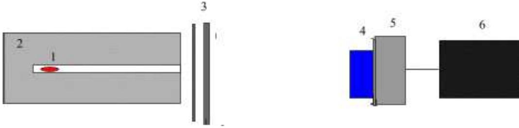
Рис. 2: 1 — Источник  $\gamma$ -квантов; 2 — свинцовый коллиматор; 3 — поглотители; 4 — кристалл NaI(Tl); 5 — ФЭУ; 6 — блок питания и пересчетная установка.
